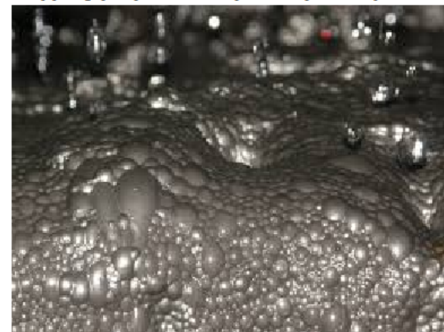
Αφρός με μέταλλευμα στην επιφάνεια
